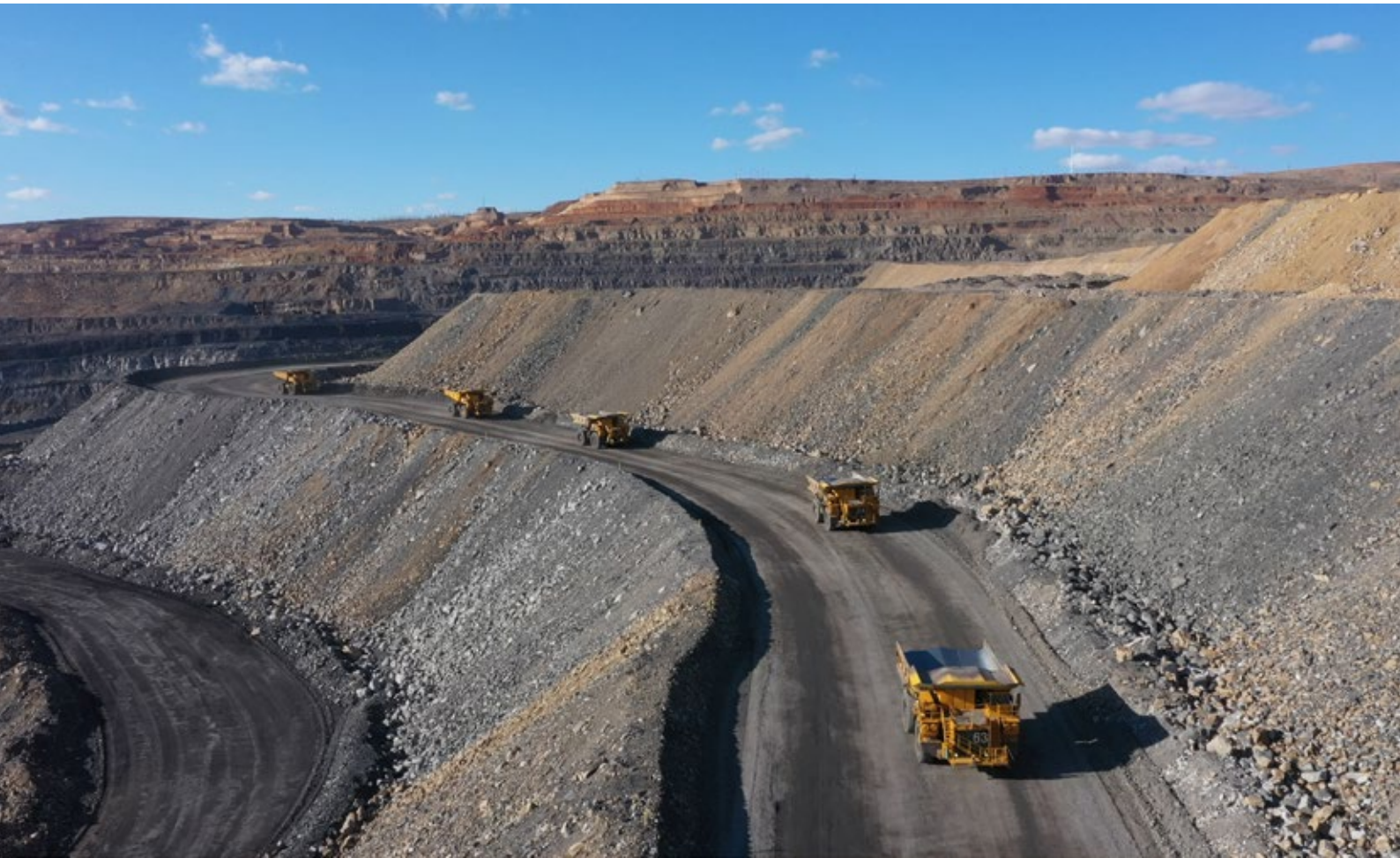
平朔集团东露天矿卡车无人驾驶项目实现设备协同编组化运行
